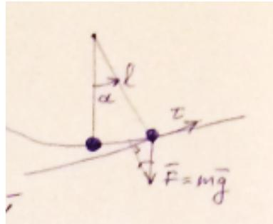
*Допущение 1:* тело имеет небольшие размеры по сравнению с длиной стержня, поэтому принимаем его за **материальную точку**
