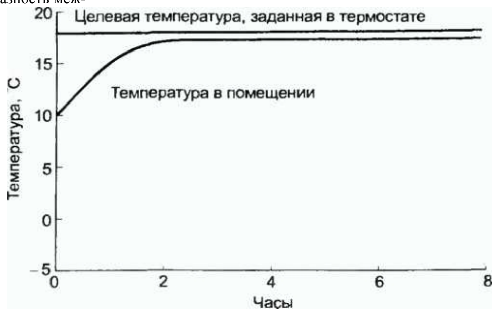
Рис. 18. Обогреватель поднимает температуру в помещении, несмотря на утечки тепла из комнаты на улицу
